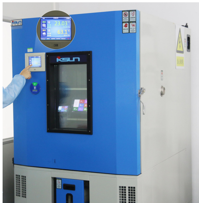
图 5-3 高低温老化测试图
